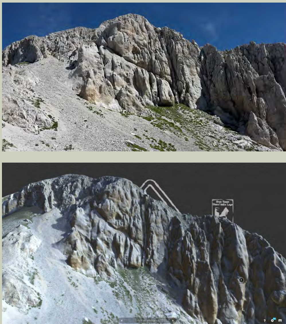
Fig. 9: Fotografia (in alto) e HRM della stessa area tramite acquisizione UAV e processamento fotogrammetrico dei dati.
